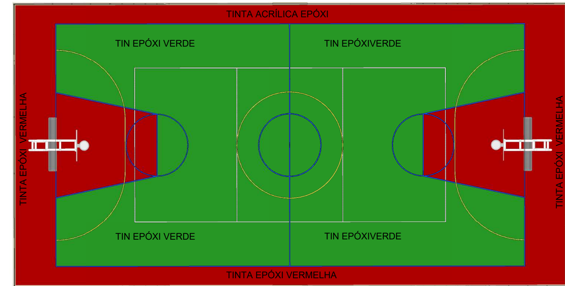
2 Detalhamento pintura de piso ESCALA - 1 : 125
